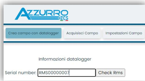
Inserire il serial number (S/N) del datalogger di riferimento e premere sul tasto “check RMS”. Se il datalogger è stato configurato in maniera corretta, si aprirà una schermata dove si dovranno inserire le informazioni richieste relative al campo da installare.
