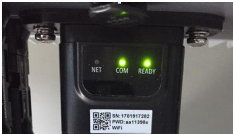
Figura 102 – Stato iniziale dei led
