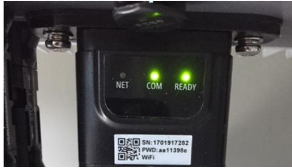
Figura 108 - Stato iniziale dei led
