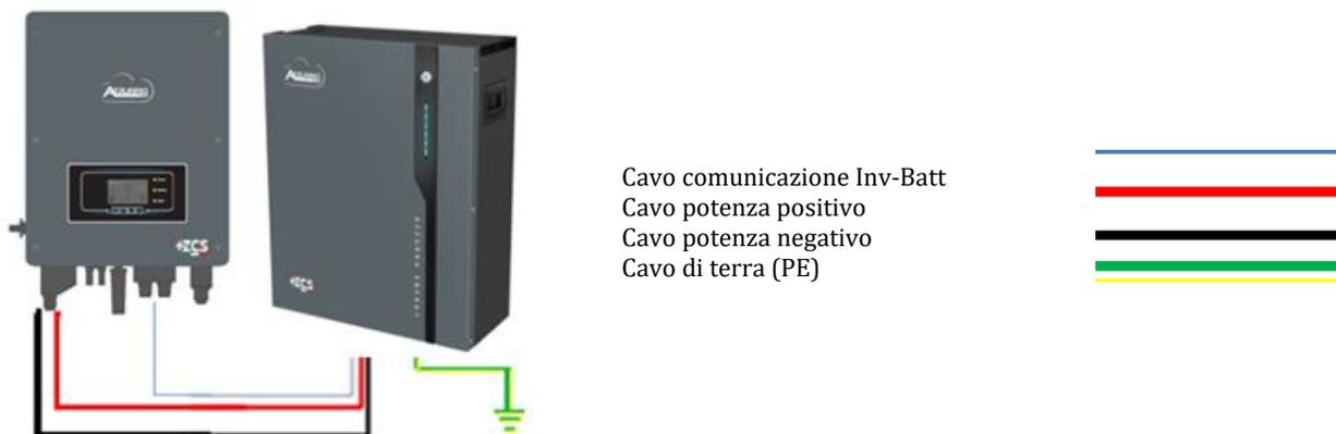
Figura 45 - Connessione batteria AZZURRO 5000
