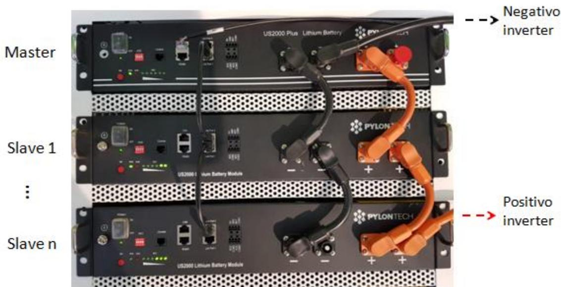
Figura 10 - Parallelo di tre batterie Pylontech
