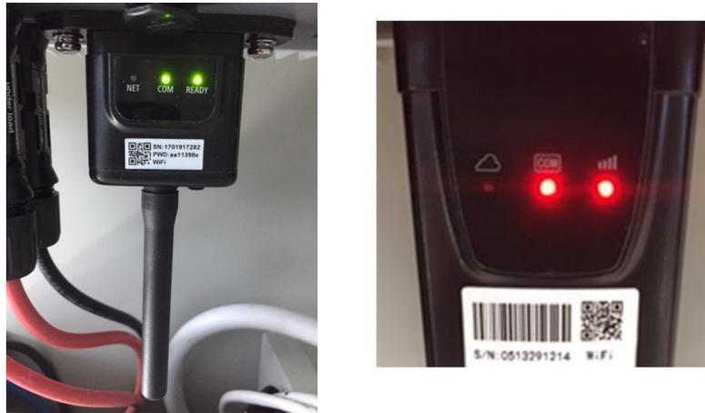
Figura 90 - Stato iniziale dei led
