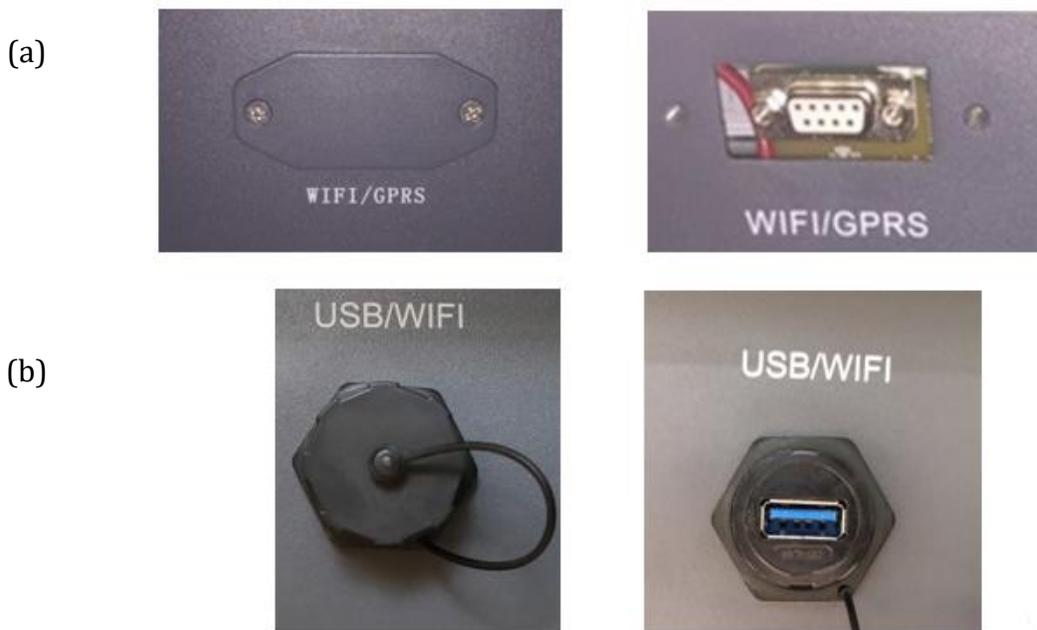
Figura 106 - Alloggiamento della scheda 4G
