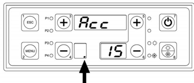
Esta es la fase de pre-calentamiento de la resistencia de encendido indicado con un punto en el display inferior izquierdo. Tiene una duración de 2 minutos y el ventilador pasa a la mínima velocidad.
