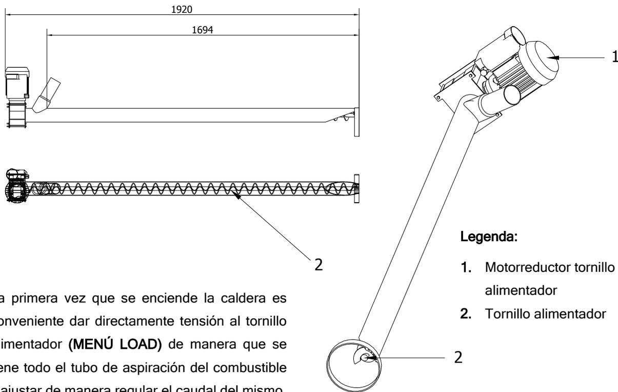
La primera vez que se enciende la caldera es conveniente dar directamente tensión al tornillo alimentador (**MENÚ LOAD**) de manera que se llene todo el tubo de aspiración del combustible y ajustar de manera regular el caudal del mismo, optimizando así el funcionamiento de la caldera.
