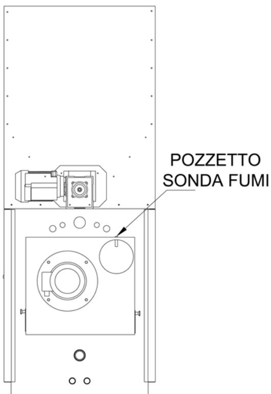
La sonda humos esta ya conectada a la tarjeta electrónica a los bornes 31 - 32 como se ve en figura de pág.15.
