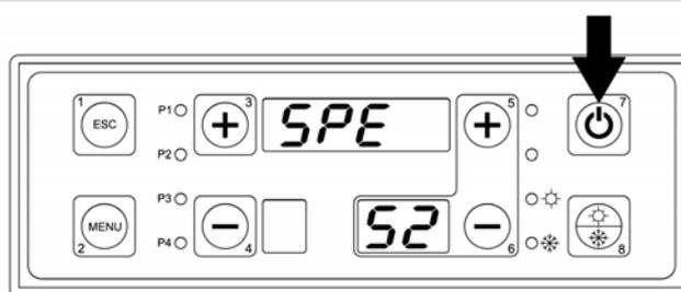
**ATENCIÓN:** para apagar la caldera hacerlo solo y exclusivamente mediante el pulsador 7 y no desconectar nunca la tensión del interruptor general verde del cuadro electrónico.
