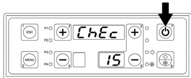
Al mismo tiempo que se activa el ciclo de funcionamiento en el display superior aparece escrito "CHEC" y arranca el ventilador a la máxima velocidad para efectuar una limpieza inicial de la boca del quemador a pellet. Esta fase dura 2 minutos.
