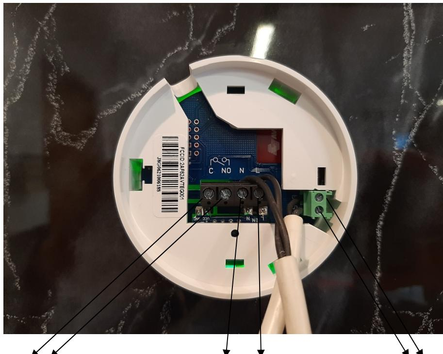
Collegamento Termostato Ambiente: contatto "pulito" proveniente dalla caldaia.
